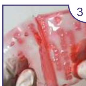
3 Pouco tempo a) Menos que 3 segundos o primeiro tempo de exposição; b) Lâmpadas não aquecidas. Aquecê-las antes de usar a máquina.
