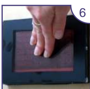
6 Pressione-os no meio para que a resina se espalhe, deixando a superfície plana e lisa, garantindo melhor qualidade para o carimbo.
