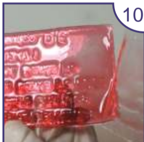
10 Retire o plástico e descarte o excesso de polímero numa lixeira reciclável. Lave a resina com água em abundância.
